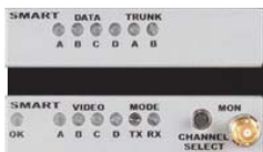
SMART前面パネル ビデオ・データI/O・ステータスLED
