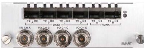
SMART背面パネル ビデオ・データI/O・ステータスLED
