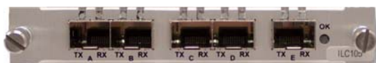
ILC105 背面パネル SFP トランシーバスロットおよびステータス LED
